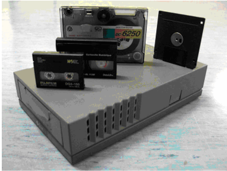
Şekil 2.14: Teyp sürücü ve çeşitli teyp kasetlerinin FDD disketle karşılaştırılması
