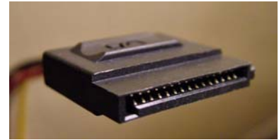
Şekil 1.36: SATA güç konnektörü (Sabit diske bağlanır)
