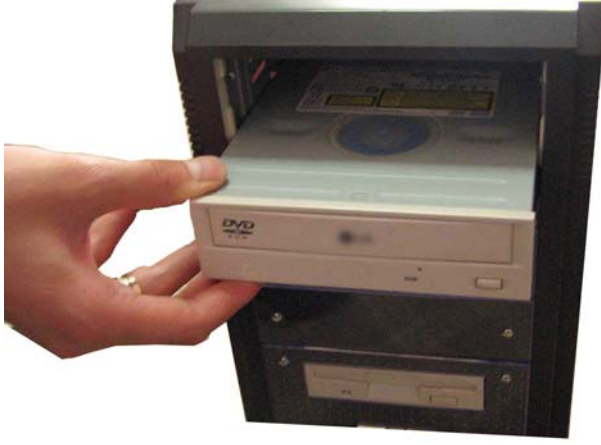
Şekil 3.16: Dahili IDE DVD sürücünün kasa içine montajı
