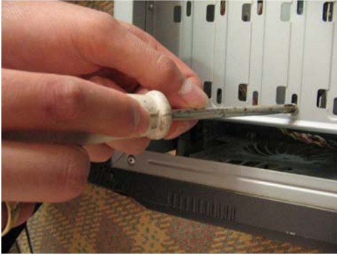
Şekil 1.47: Sabit diskin vidalanması
