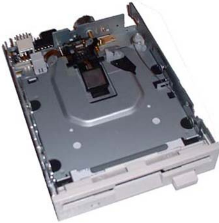
Şekil 2.7: Disket sürücünün iç görünüşü
