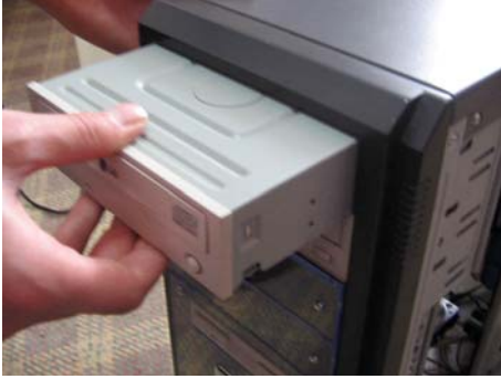
Şekil 3.26: İkinci optik sürücünün montajı
