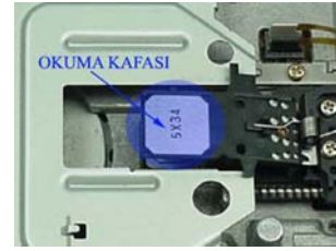
Şekil 2.8: Disket sürücünün okuma kafası
