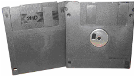
Şekil 2.1: Disket sürücüde kullanılan 3,5" disketin ön ve arka yüzü
