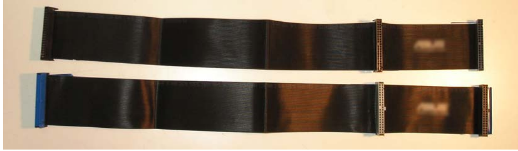
Şekil 1.15: 40 telli ve 80 telli paralel ATA kabloları
