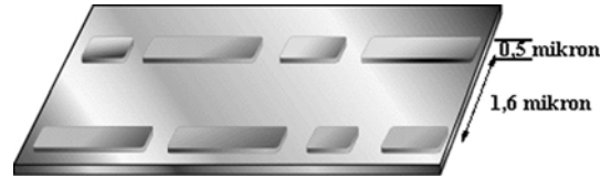
Şekil 3.3: CD-ROM'un yüzey yapısı
