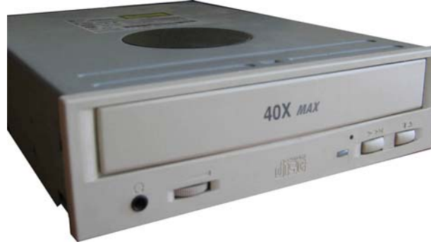
Şekil 3.6: 40X veri okuma hızına sahip CD-ROM sürücü
