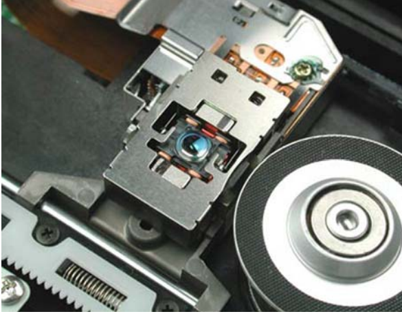
Şekil 3.12: CD yazıcının iç donanımı
