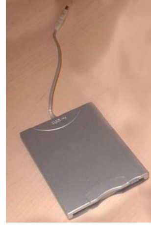
Şekil 2.4: USB arayüzlü harici 3,5” disket sürücüsü
