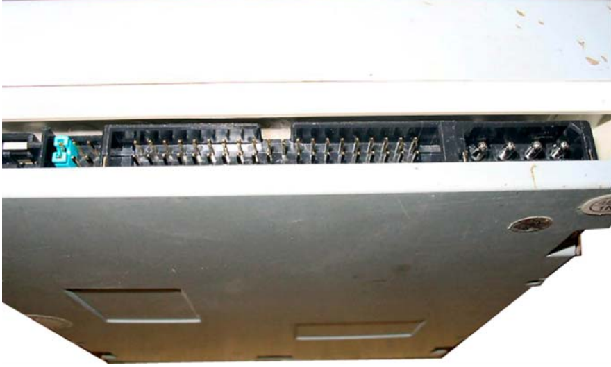
Şekil 3.23: IDE ara birimli ATAPI optik sürücünün bağlantı noktaları
